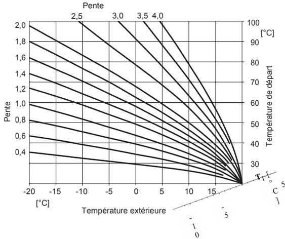
**Diagramme de courbes de chauffe avec ☀, ☾ - mode et chauffage ⏻ (ARRÊT avec fonction antigel)**
