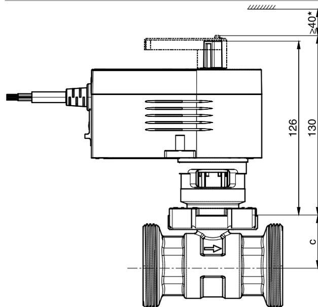
\*) avec contact auxiliaire inverseur 0510480001 ou 0510480002 : ≥ 72 mm
